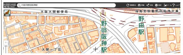
2-3 大阪市野田阪神駅周辺 ズームレベル18 元図は、電子地形図 25000 から電子国土基本図 2500 レベル (基盤地図情報:縮尺 2500 分の1相当: 2500 レベル) に置き換わり、実線の道路は幅のある道路に変化しています。(地理院地図より作成)
