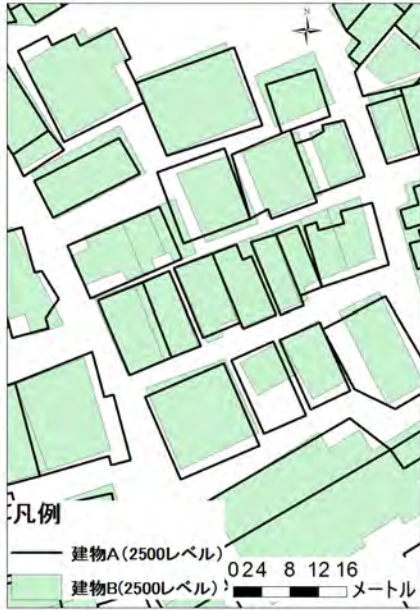
図1 同じ位置精度 (2500 レベル) でも作成者 (作成基準等) の違いで位置ずれする建物 1995年阪神淡路大震災調査素図より碓井作成
