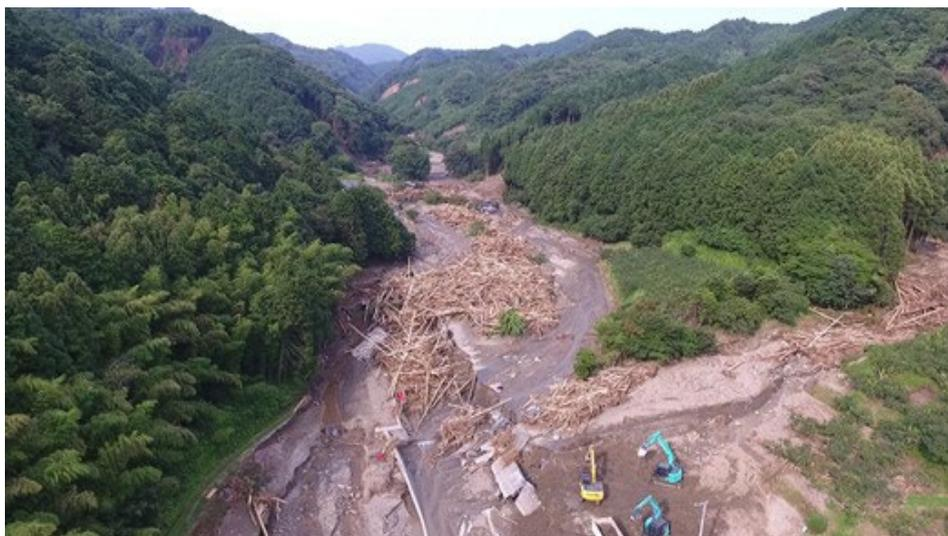
図1 豪雨による表層崩壊の一例（俯瞰）（山口県防府市にて，八反地撮影）
