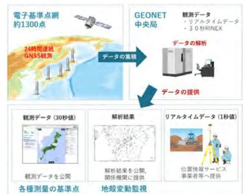
図 2 0 GEONET (GNSS連続観測システム)
