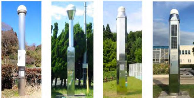
図 1 9 主な電子基準点の外観
