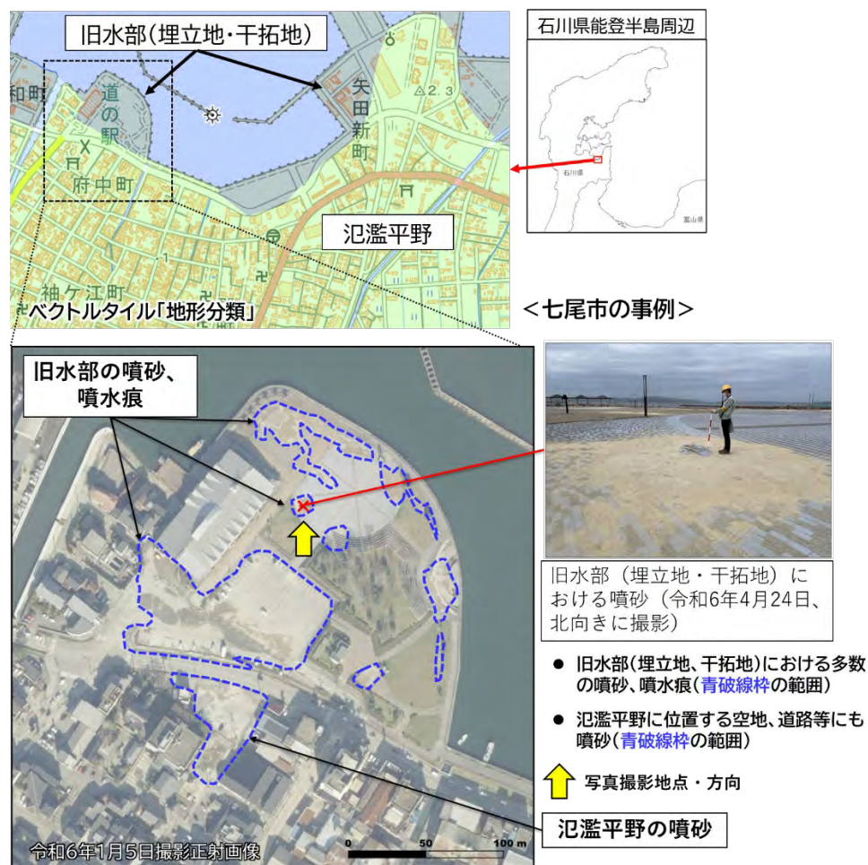
図 13 令和6年能登半島地震に伴う石川県七尾市における液状化と地形分類との関係
